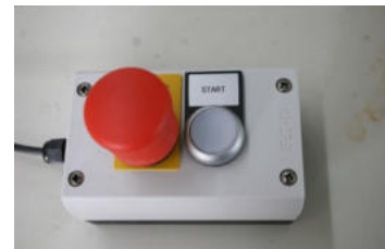
Start möglich über externen Schalter mit Notaus
