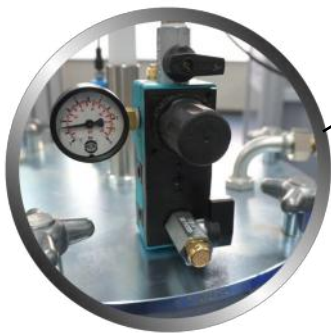
Pneumatikeinheit Pressluft-Zufuhr mit Entlüftung Druckbehälter
